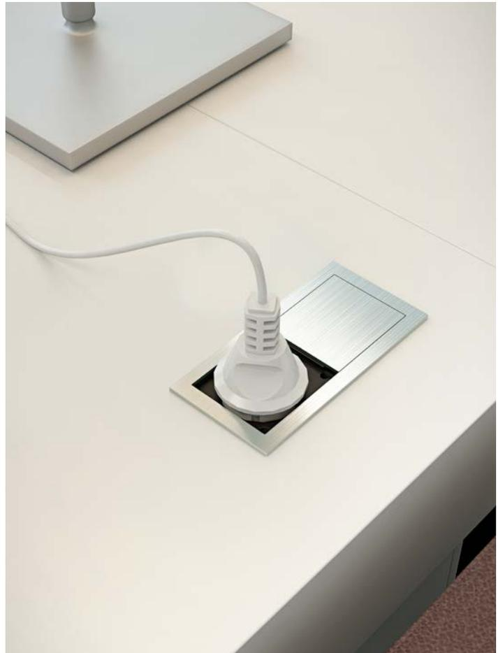
El sistema de apertura funciona en dos etapas: primero presionando el botón, la cubierta se desliza mostrando el enchufe. Segundo deslizamos la cubierta de forma manual para abrir completamente el enchufe.
